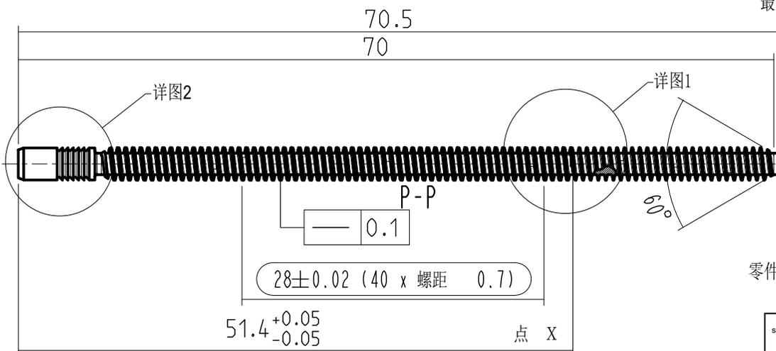
零件必须使用螺纹旋转进行制造
